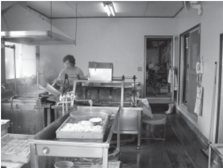
製麺所内部。せいろの向こうはうどんをしめるためのローラー。左手の釜で茹で上げて、直接滑り入れらる。
